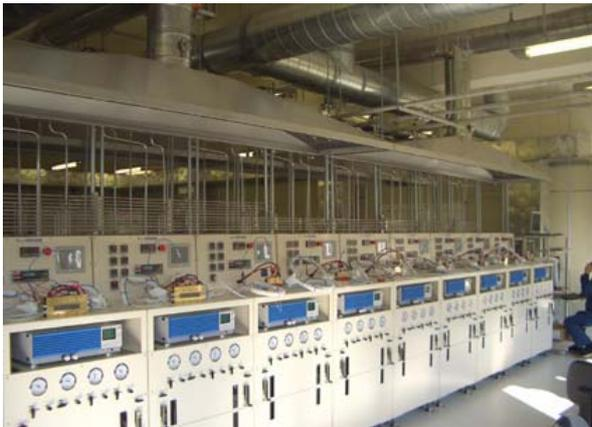
Photo 1 漏洩ガスの流路制御用フード設置事例
