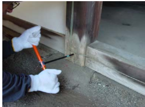
Photo 3 成長錐による小コア採取 Sampling a Small Wood Core with a Increment Borer
