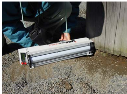
Photo 5 レジストグラフによる測定 Measurement of the Drilling Resistance with a Resistograph
