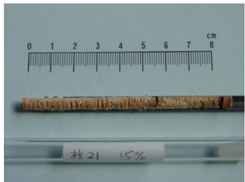
Photo 4 採取した小コア材 Sample of a Small Wood Core
