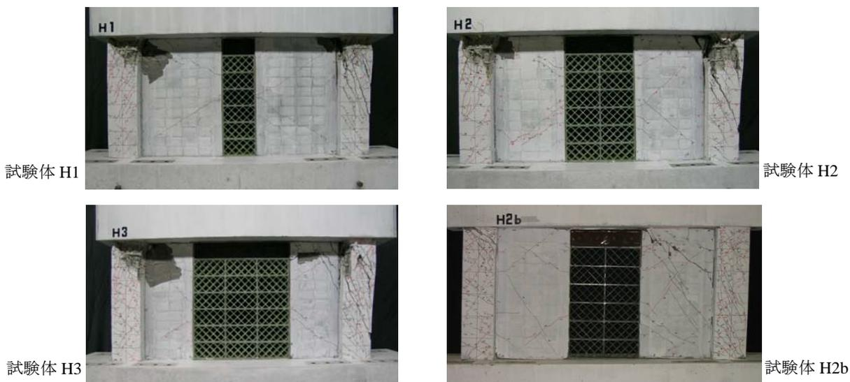
Photo 2 最終破壊状況
