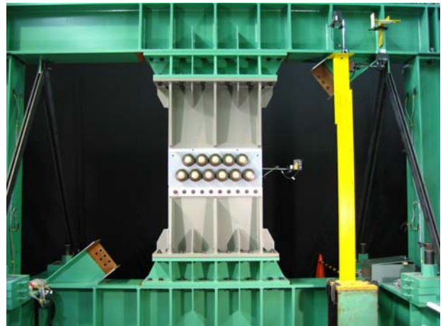
Photo 2 間柱型ダンパー用鉄骨フレーム Loading Frame for Stud Type Brake Damper
