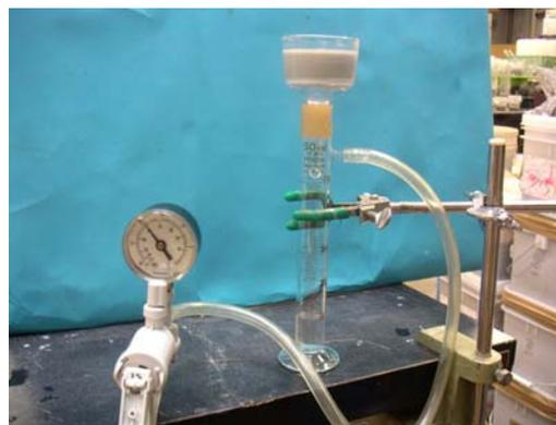
Photo 1 減圧脱水試験装置
