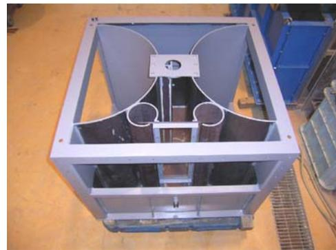
Photo 3 遮水壁模型土槽
