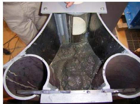
Photo 4 遮水材の充填状況
