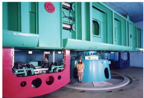
Photo 1 遠心模型実験装置
