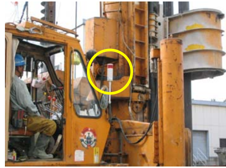
Photo 4 重機に設置したパトライト Warning Light on a Construction Machine
