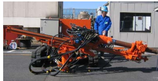
Photo 1 ハイスペックネイリング工法専用の施工機械 Machine of New Soil Nailing Method
