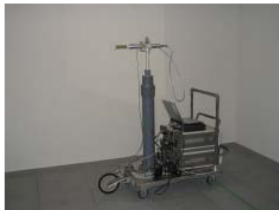
Photo 1 距離計測輪つき測定台車とダイポール Chassis with the Distance Measurement Tire and Dipole
