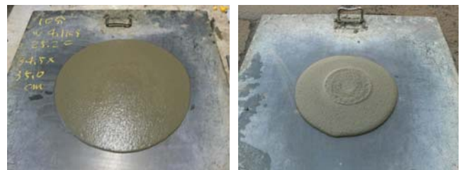
Photo 6 流動性が良好な状況 Good Fluidity Photo 7 流動性が低い状況 Low Fluidity
