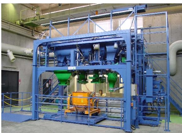
Photo 1 — 高信頼性コンクリート製造システム —
