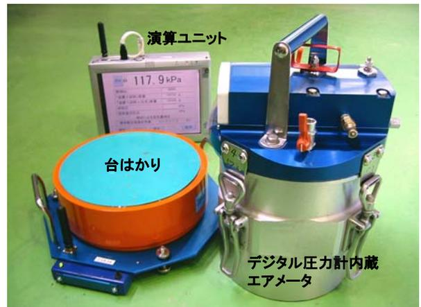
Photo 1 単位水量測定装置の外観
