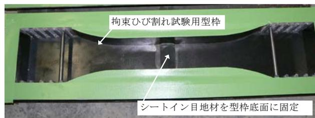
Photo 3 拘束ひび割れ試験用型枠
