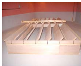
Fig. 15 パネルの吸音率測定 Measurement of Sound Absorption Coefficient
