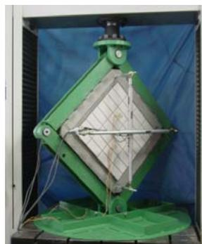
Photo 4 対角線圧縮せん断加力実験
