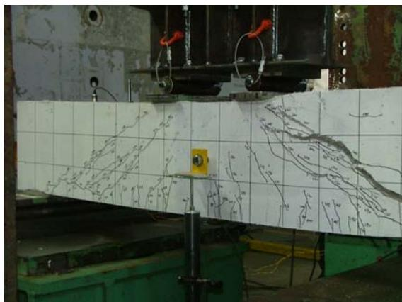
Photo 10 終局時の破壊状況 (S-F)
