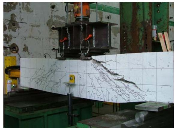
Photo 11 終局時の破壊状況 (S-FS)
