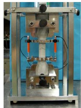
Photo 4 一軸直接引張試験
