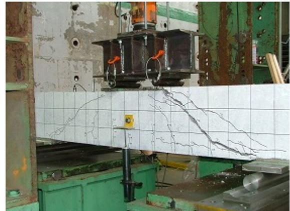
Photo 9 終局時の破壊状況 (S-C)
