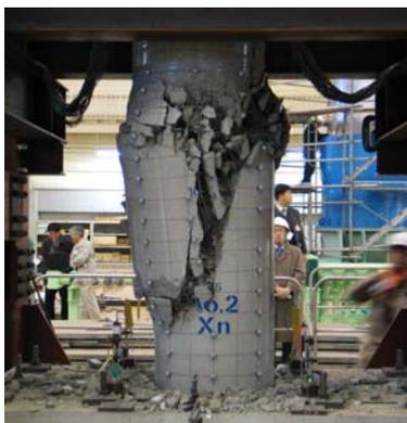
Photo 1 段落し破壊 (PWRI-2-80)
