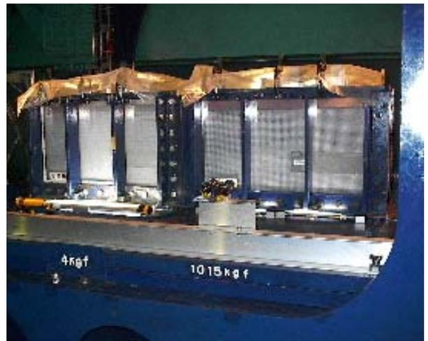
Photo 2 遠心载荷装置に搭載させた模型 (右:Case2, 左:3)
