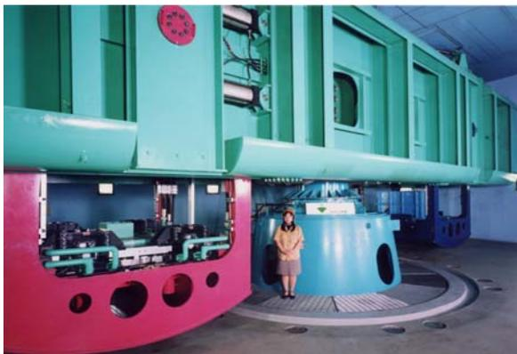
Photo 1 遠心载荷模型実験装置
