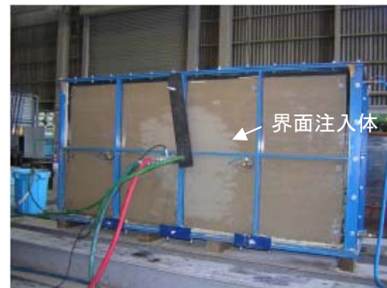
Photo 3 注入開始後1分が経過した注入試験(ケース1) Situation of One Minute after the Injection Begins (case1)
