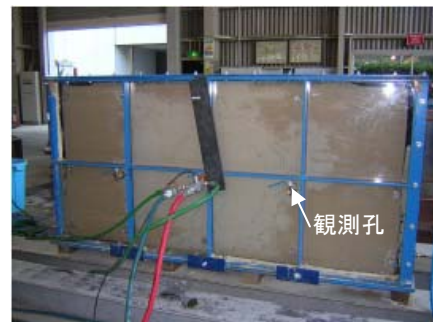
Photo 4 注入開始後5分が経過した注入試験(ケース1) Situation of Five Minutes after the Injection Begins (Case1)
