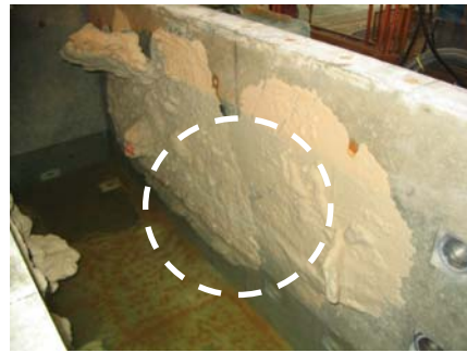
Photo 6 コンクリート製土槽を用いた注入試験(ケース2) Situation of Injection Test Used Medium Soil Tank Made by Concrete (Case2)
