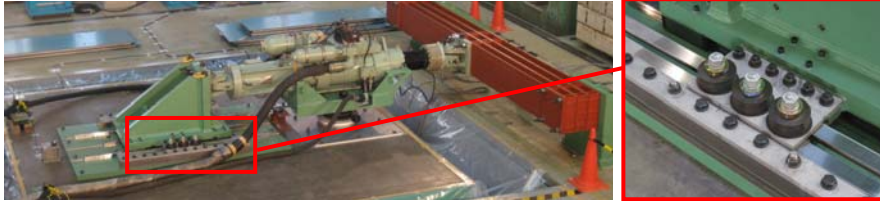
Photo 2 実大規模トリガー機構の検証試験体 Test of Full Scale Trigger System
