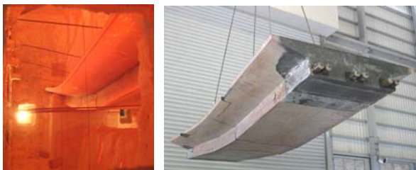
【炉内加熱状況】 【実験後の試験体】
