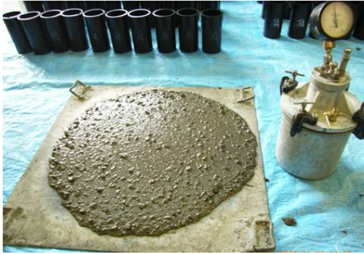
Photo 1 スランプフローと空気量の測定状況 Measurement of Slump Flow and Air Volume
