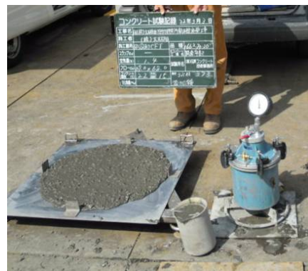
Photo 6 コンクリートのフレッシュ試験状況 Test of Fresh Concrete
