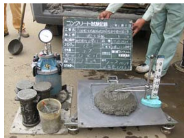
Photo2 再生コンクリートの受入試験状況 Delivery Inspection of Recycled Concrete
