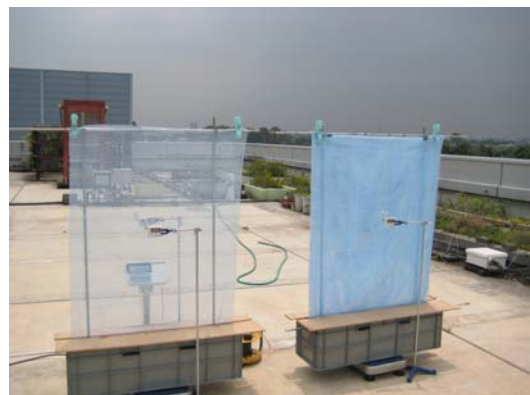
Photo 1 スクリーンの蒸発量の測定の様子 Measurement of the Amount of Evaporation from a Screen
