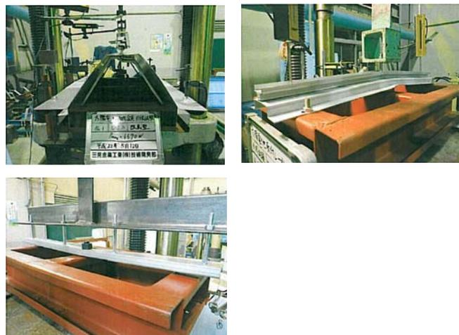
Photo 1 取り付けシステム引張試験
