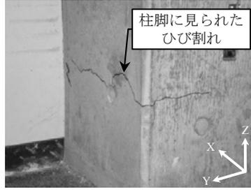
Photo 7 擁壁衝突実験後の柱脚ひび割れ (位置: X3 - Y3 の 1F 柱脚)
