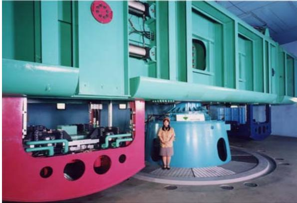
Photo 2 遠心模型実験装置
