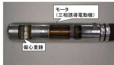
Photo 2 内部振動機の振動体内部の構造
