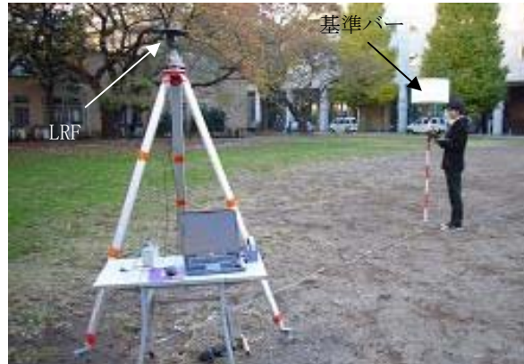
Fig. 6 LRFを用いた位置計測システムの実験状況 Experiment Situation of Proposed Position Measurement System Using LRF
