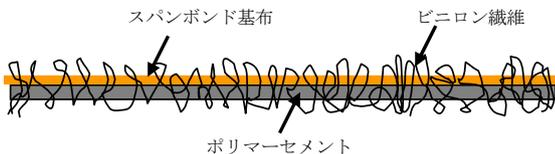
Fig.1 ウェブフォームの断面構成
