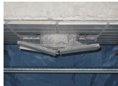
Photo 8 面外変形に対する剥落防止効果
