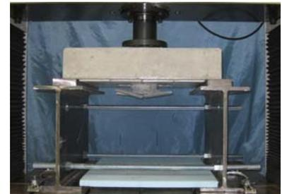
Photo 7 押抜き試験状況
