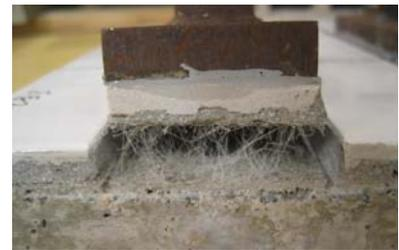
Photo 6 ウェブフォームの破断状況
