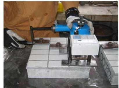
Photo 4 接着強度試験状況
