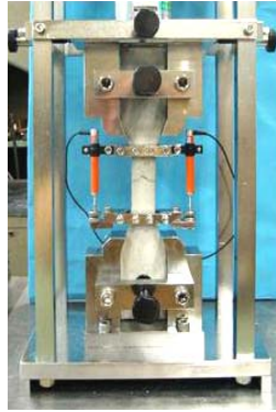
Fig. 4 試験体の形状 Photo 6 一軸直接引張試験 Tensile Strength Test Piece Uni-axial Tensile Strength Test
