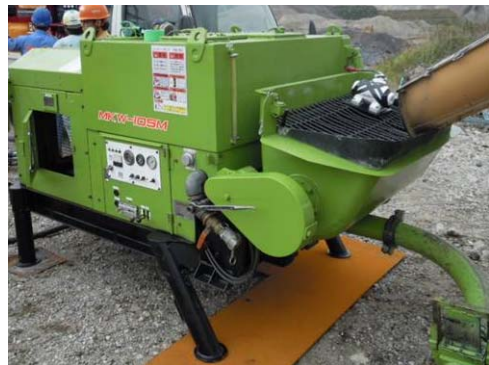
Photo 4 定置式10m 3 タイプポンプ 10m 3 pump
