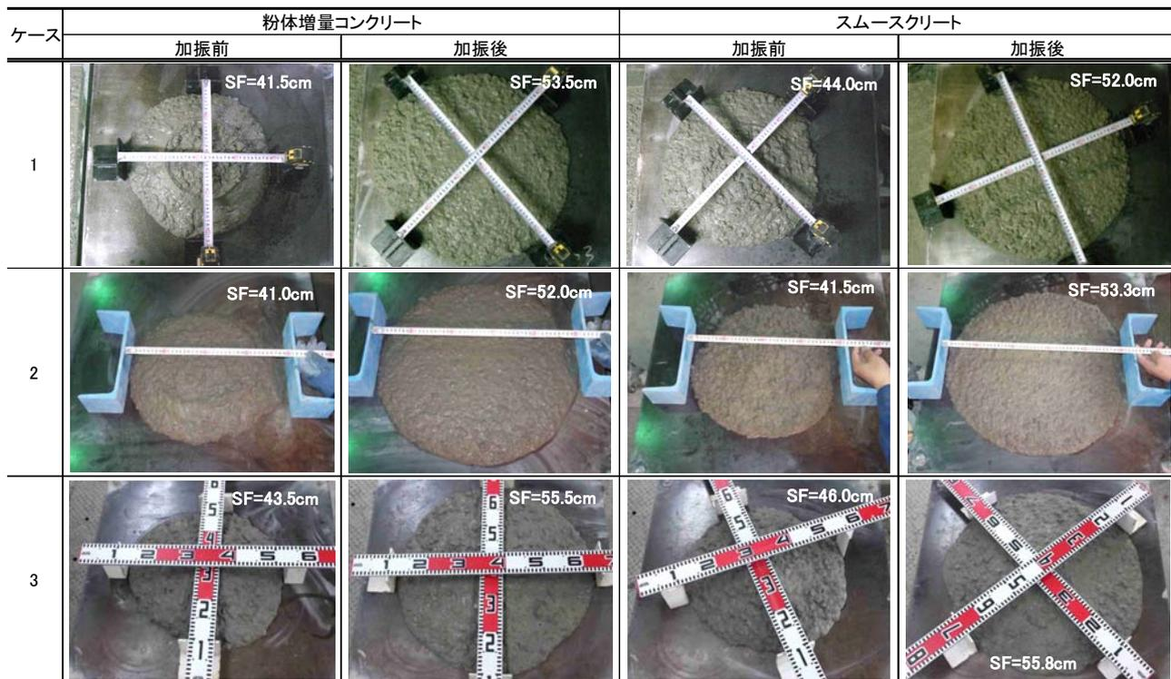
Photo 2 加振変形量試験前後のコンクリートの状況
