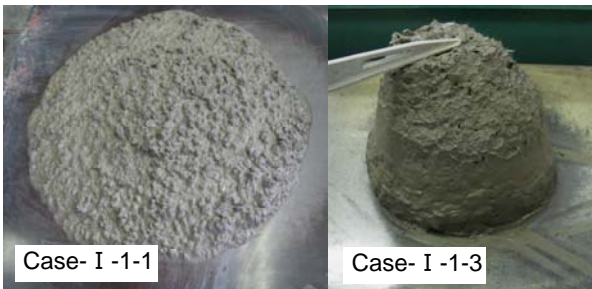
Photo 3 スランプフローおよびスランプの例 Example of Slump Flow and Slump
