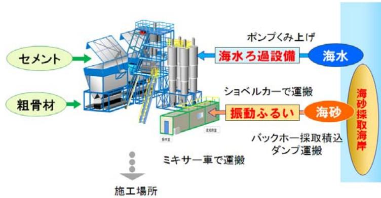
Fig. 10 海水練り・海砂コンクリートの製造方法
