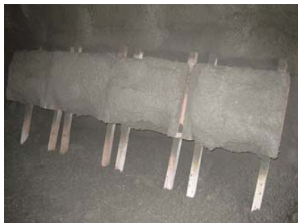
Photo 1 箱型枠に吹付けしたブロック試験体 Block Specimen of Shotcrete in a Box
