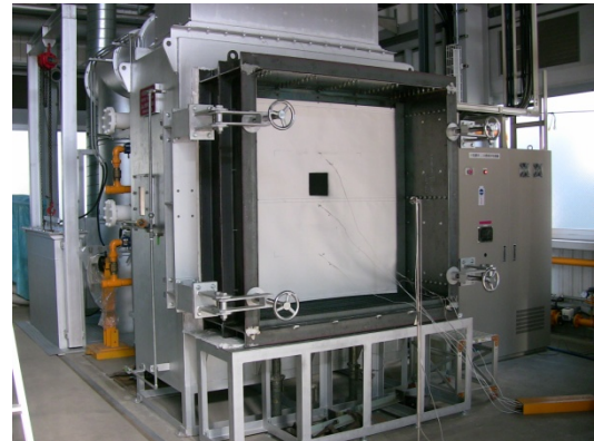
Photo 4 壁炉に取り付けられた試験体 Specimen Attached Fire Testing Furnace
