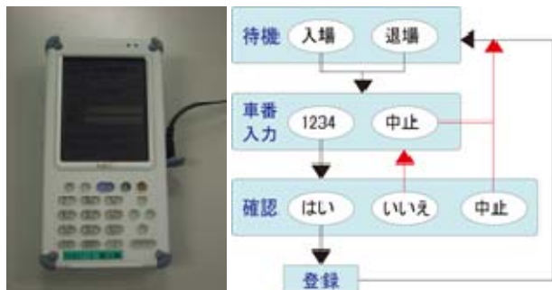
Fig. 11 音声認識端末による車両番号登録フロー Vehicle Registration Process with Voice Detection System
