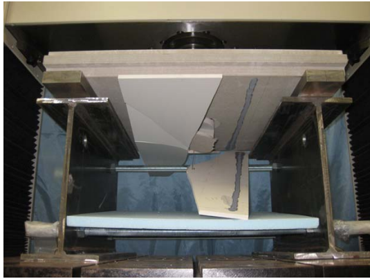
Photo 4 金物併用部分弾性接着剤張り工法 タイル剥落状況
