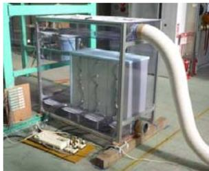
Photo 3 ラック端部実験用の縮小模型のセットアップ
