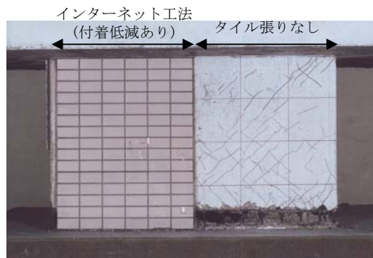
Photo 3 破壊後のインターネット工法によるタイル張り Appearance of Tiling Utilizing a Fabric and Anchor Method
