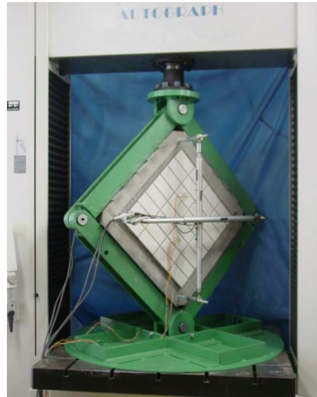
Photo 4 対角線圧縮せん断加力実験の状況 Compression Shear Loading Test
