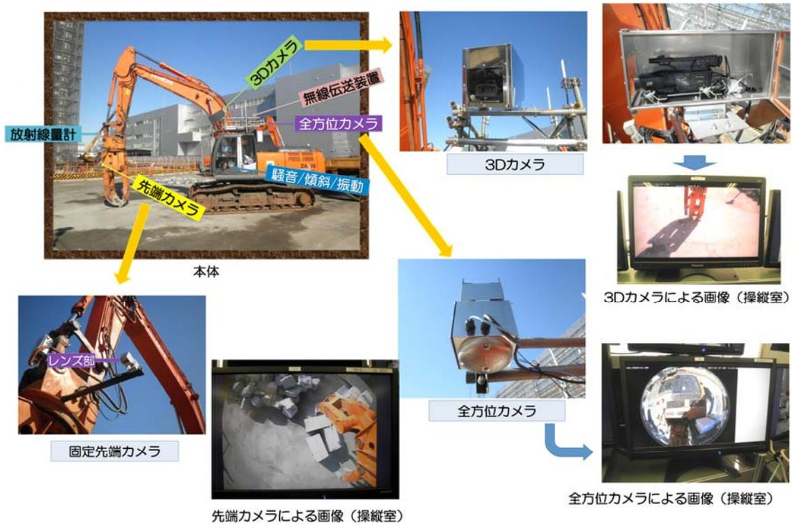
先端カメラによる画像 (操縦室)
