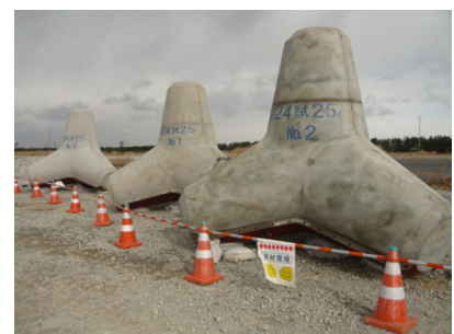
Photo 1 海水練り・海砂コンクリート技術で製造した消波ブロック Wave Dissipation Blocks Made with Sea Water
