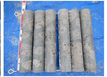
Photo 7 ブロックより 採取したコア供試体 Core Samples
