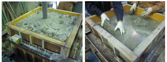
(a) プレパックドコンクリート (b) ポストパックドコンクリート
