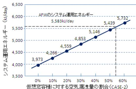
Fig.8 ブラインドの気密性による影響 (西面)
