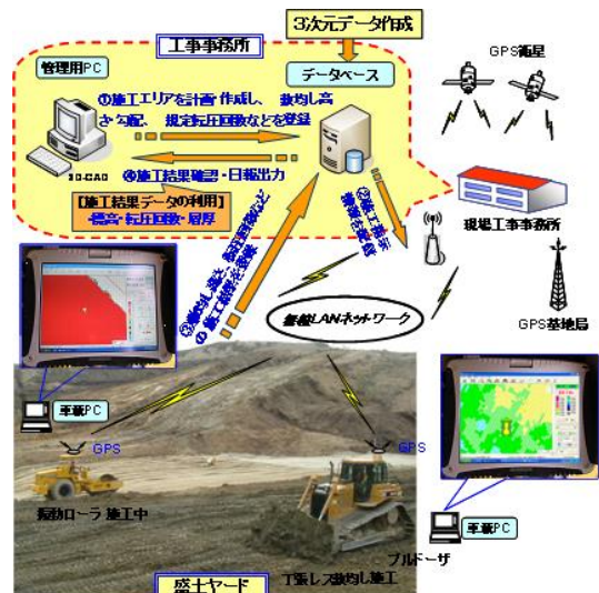
Fig. 10 「αシステム」を拡張した土工事 統合管理システム運用の流れ Operation System of the Earthworks Extended "α System"
