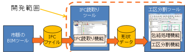
Fig. 4 システムの機能構成 Inspection Work Flow Using the Tool
