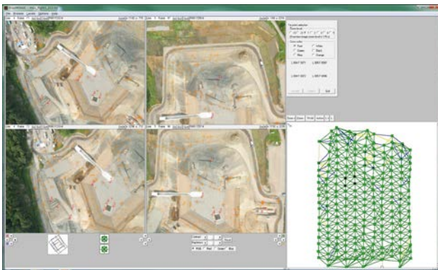
Fig. 7 写真の結合（特徴点のマッチング） Combination of the Photograph (Matching of the Characteristic Point)
