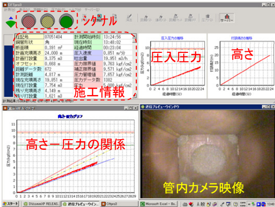
Fig.5 CFTproΣ ® のパソコンの画面例 Example of Screen of the CFTproΣ
