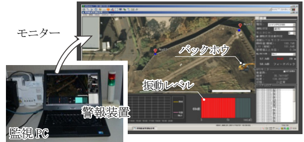
Photo 2 リモート監視システム Remote Supervising System
