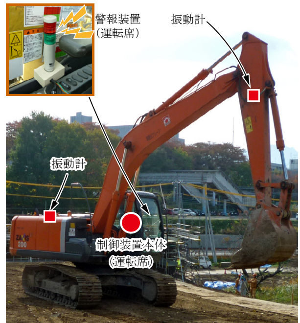
Photo 1 制御システム Control System
